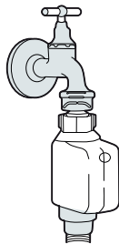
tubo de suministro de seguridad
