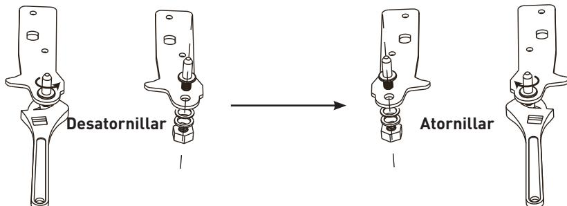
6. Vuelva a colocar el soporte colocando el pasador de la bisagra inferior. Vuelva a colocar ambas patas ajustables.
