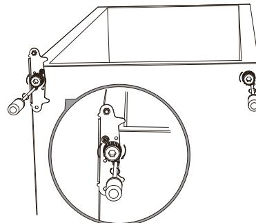
7. Plaats de deur terug. Zorg ervoor dat de deur horizontaal en verticaal uitgelijnd is zodat de afdichtingen aan alle zijden gesloten zijn voor u de bovenste scharnier vastdraait.
