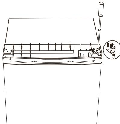
4. Desatornille la bisagra inferior. Luego retire las patas ajustables de ambos lados.
