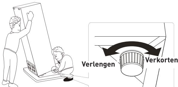
Indien het toestel niet waterpas is, passen de deuren en magnetische dichtingen niet goed
