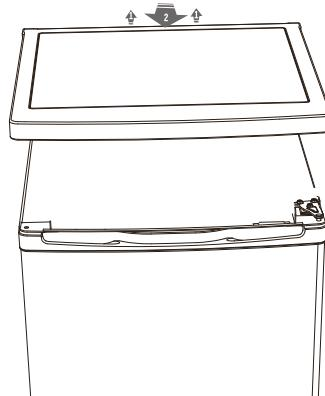
3. Schroef de bovenste scharnier los. Verwijder dan de deur en leg ze op een zacht oppervlak om krassen te vermijden.
