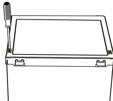
9. Retire las juntas de la puerta del frigorífico y del congelador y luego fíjelas después de girarlas.
