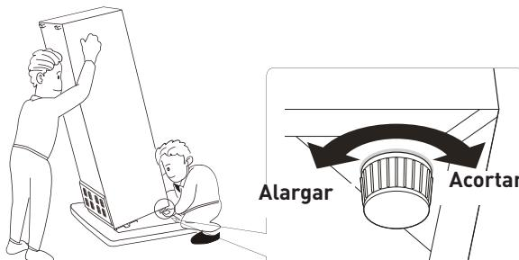
Si el aparato no está nivelado, las puertas y la alineación de la junta magnética no encajarán adecuadamente
