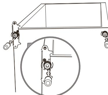
7. Replacez la porte. Assurez-vous d'aligner la porte horizontalement et verticalement, de façon à ce que les joints soient hermétiques de tous les côtés, avant de resserrer la charnière supérieure.
