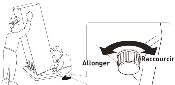
Si l'appareil n'est pas droit, les portes et joints magnétiques ne seront pas correctement alignés
