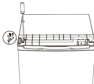
8. Coloque la tapa superior y fíjela con 2 tornillos en la parte posterior.
