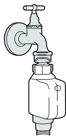
tubo de suministro de seguridad
