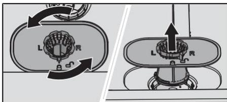
1. Tournez la bague de verrouillage dans le sens antihoraire et soulevez le filtre.
