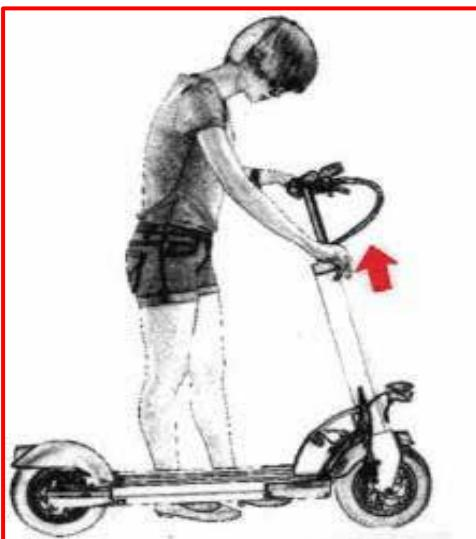
Ajuste el tamaño de su manillar aflojando la abrazadera de la potencia. Tenga cuidado de no sobrepasar el límite de altura indicado. Comprueba que tu manillar es estable y que la abrazadera está bien ajustada.
