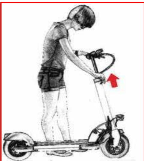
Ajustez la taille de votre guidon en desserrant la boucle de serrage situé sur la potence. Attention à ne pas dépasser la hauteur limite indiqué. Vérifiez que votre guidon est bien stable et que le collier de serrage est bien serré.
