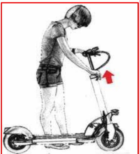
Stel de hoogte van uw stuur af door de klem op de stuurpen los te maken. Let op dat u de aangegeven maximale hoogte niet overschrijdt. Controleer of het stuur goed vastzit en of de klem stevig is aangedraaid.
