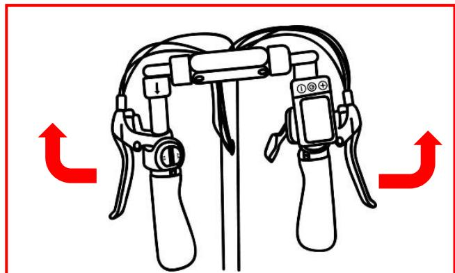
Klap de handgrepen eenvoudig uit door ze rechtop te zetten. Controleer of ze goed vastzitten voordat u uw product gebruikt.
