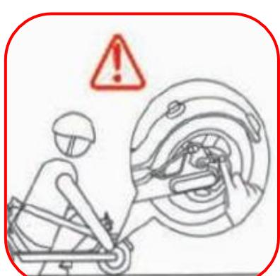
No toque los frenos de disco después de usar su trotinete, estas partes pueden estar calientes después de un largo viaje
