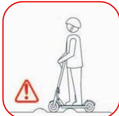
Cuando conduzca por terrenos inestables e intransitables, reduzca la velocidad.
