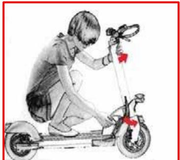
Plaats vervolgens de beveiligingslus terug in de oorspronkelijke positie en controleer of het stuur stabiel is.
