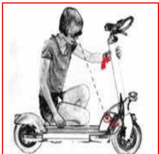
Trek vervolgens aan de vouwhendel en laat de stuurpen zakken naar het platform van uw elektrische step. Zodra deze volledig is neergeklapt, plaats de beveiligingslus terug in de oorspronkelijke positie.
