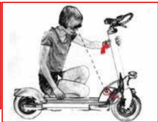
A continuación, tire del asa de plegado y baje la potencia hacia la bandeja de su scooter. Una vez que lo haya bajado al máximo, vuelva a colocar la hebilla de seguridad en su posición original.
