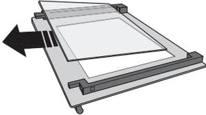
3. Remplacez la paroi du milieu (marquée d'un « 1R ») avant de remplacer la paroi intérieure : Pour placer correctement les parois de verre, assurez-vous que la marque « R » se trouve dans le coin gauche. En premier, insérez la longue partie de la vitre marquée d'un « R » dans les appuis des guides, abaissez-la ensuite en place. Répétez cette procédure pour les deux parois de verre.
