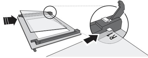
4. Remplacez le bord supérieur : un déclic indique qu'il est bien placé. Assurez-vous que le joint est bien placé avant de remonter la porte.
