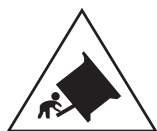
Attention, risque de basculement
