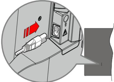
Voer een uiteinde (de stekker met twee openingen) van het geleverde verwijderbare netsnoer in de netsnoer inlaat van de TV zoals hierboven weergegeven. Over daarna het andere uiteinde van het netsnoer in het stopcontact.
