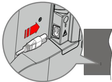
Branchez une extrémité (la fiche à deux trous) du cordon d'alimentation détachable fourni dans l'entrée du cordon d'alimentation située à l'arrière de la TV, comme indiqué ci-dessus. Branchez ensuite l'autre extrémité du cordon d'alimentation dans la prise de courant.
