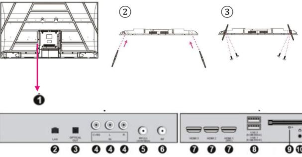
**Important:** Utilisez un câble d'antenne de 75 Ω pour éliminer les interférences. Le câble d'antenne ne doit pas être proche du cordon d'alimentation. Lors de l'utilisation de la télévision par câble, insérez directement la prise d'antenne de 75 Ω dans la prise murale, laquelle doit être reliée à l'antenne collective de l'immeuble ou à l'antenne du toit de la maison
