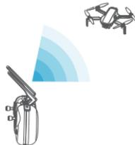
Lorsque le drone vole à haute altitude directement au-dessus de la télécommande, la qualité de la communication est considérablement réduite en raison du mauvais angle de l'antenne. Réduisez l'altitude ou volez horizontalement sur une certaine distance en orientant autant que possible l'antenne de la télécommande vers le drone, comme indiqué sur la figure.
