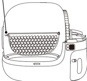
⑧ Installez le capot latéral et faites-le pivoter dans le sens des aiguilles d'une montre, puis installez le capot latéral magnétique.
