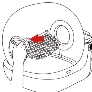
⑥ Fixez l'autre côté du tamis à litière au point B du cylindre.
