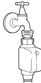
Tuyau d'arrivée d'eau de sécurité
